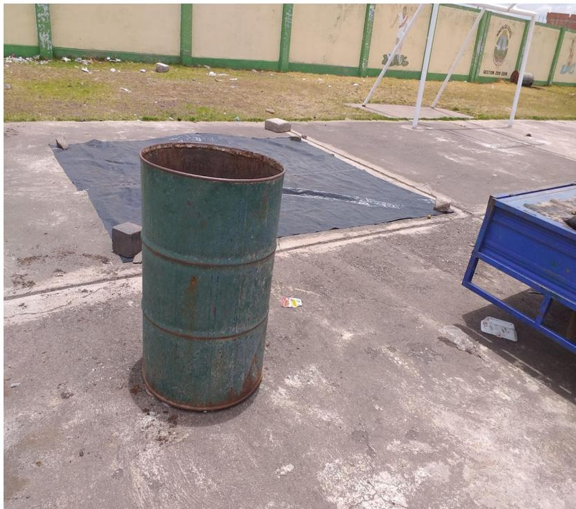
Figura 21: Envase para la determinación de densidad de residuos sólidos
